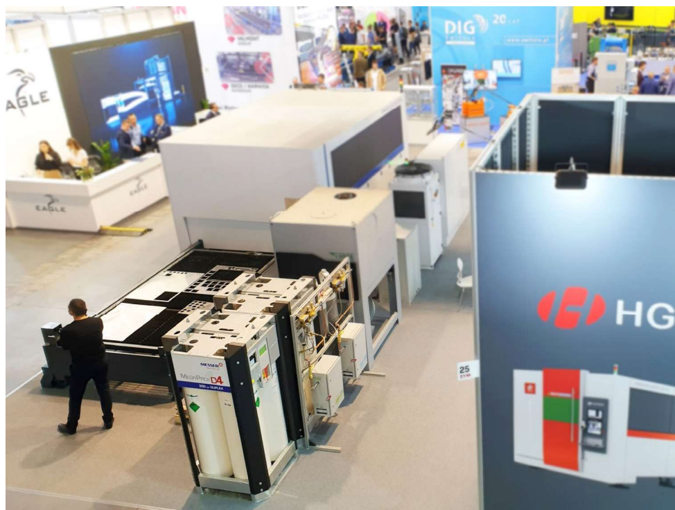
Rys. 1. Urządzenie do cięcia wraz ze stołem i systemem zasilania w gazy techniczne
