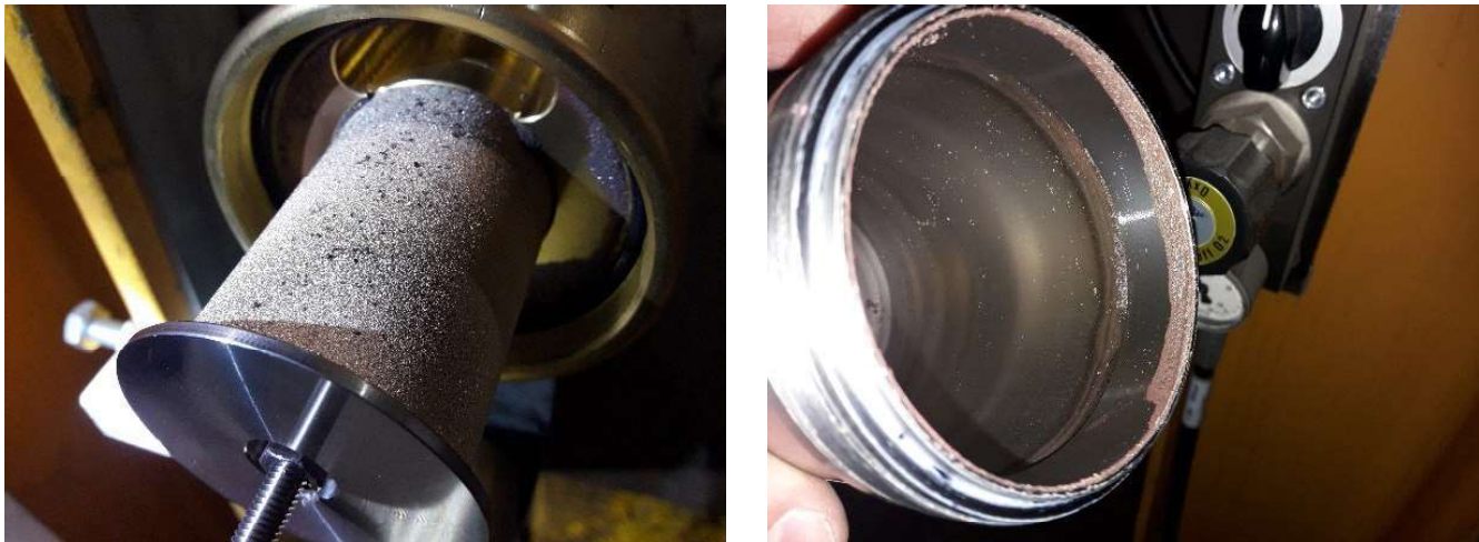
Rys. 2. Zanieczyszczenia na elementach filtra
